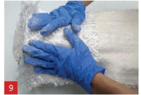
9 Presione la fibra A1 triaxial. La fibra es maleable y se ajusta muy bien a la forma del molde.
